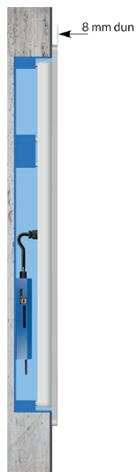
Zijaanzicht: TV ingebouwd in de muur.
